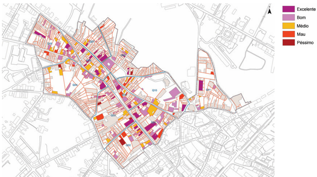
Planta 28: Edifícios com frações desocupadas e respetivo estado de conservação
