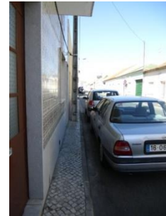
Figura 27 - Rua das Milheiras – passeios reduzidos e sem condições para a circulação de pessoas
