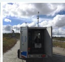
Estação móvel de monitorização da qualidade do ar
