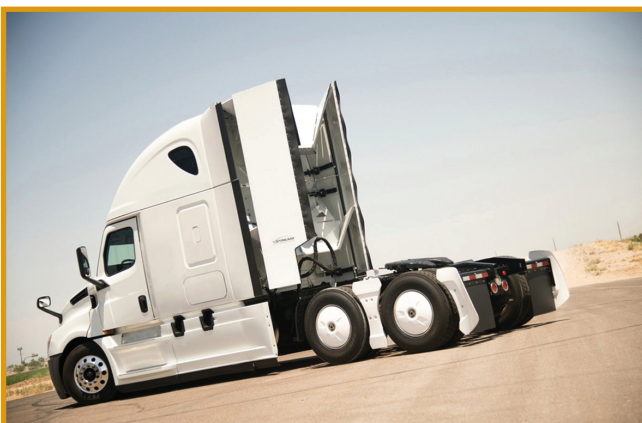
Foto do Sistema TruckWings da Xstream Trucking que reduz o consumo de combustível por melhoria da aerodinâmica diesel e já tem 2.000 pré-reservas
